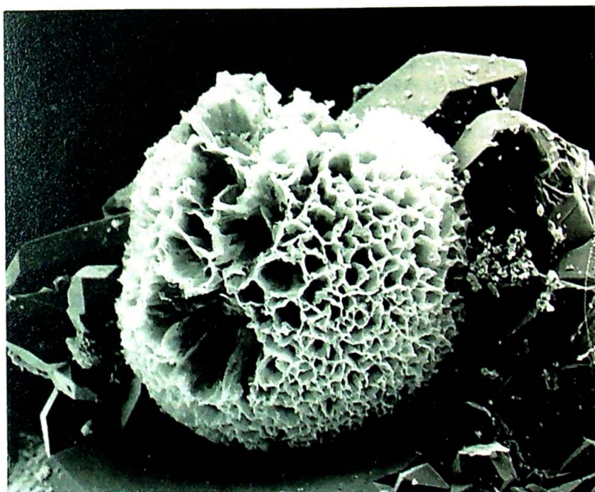
Fig. 4. SEM-foto av beyeritt som en kuleformet rosett på kvartskrystaller. Diameteren på kula er ca. 0,25 mm.
