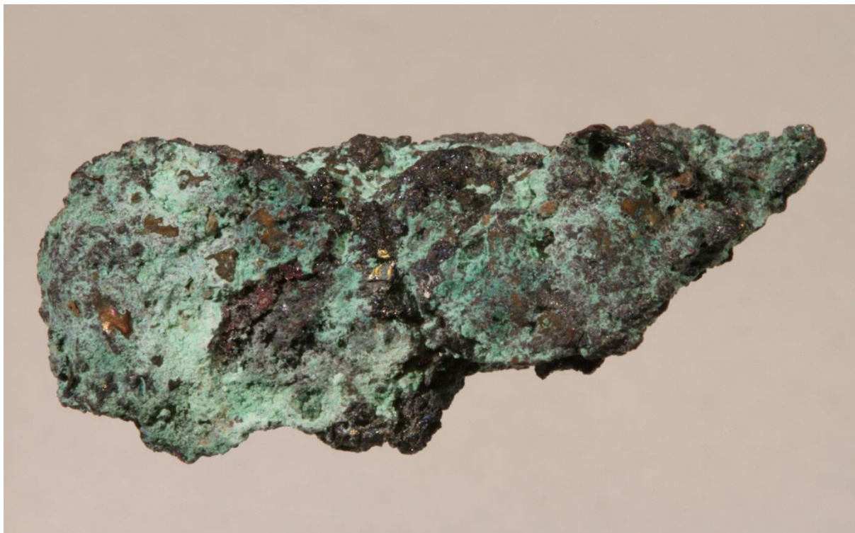
Fig. 2. En uregelmessig masse av djurleitt med et blek grønt sekundærbelegg som består av en blanding av atacamitt og paratacamitt. Mindre mengder kobber og små, røde flekker av cupritt kan også sees på prøven. Størrelse: 28 x 12 mm. Samling (MM-4924) og foto: KEL
