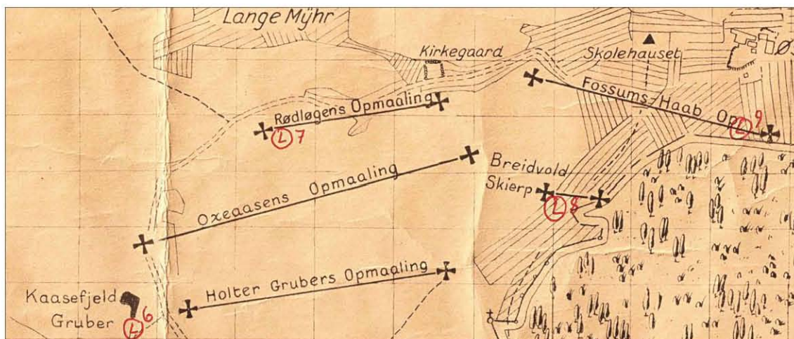
Fig. 4. Utsnitt av et kart som ble tegnet av Asmundsen i 1813 og fremlagt av Tellef Dahll ved en utmålsforretning i 1873. Kirkegården sees i øvre del av kartet. Malmdraget «Rødløgens Opmaaling» går parallelt veien til kirkegården og L7 angir Rødløgen gruve. Rutenettet angir tønner land og horisontal lengde av en rute er ca. 85 m. NGU Bergarkivet K2592.
