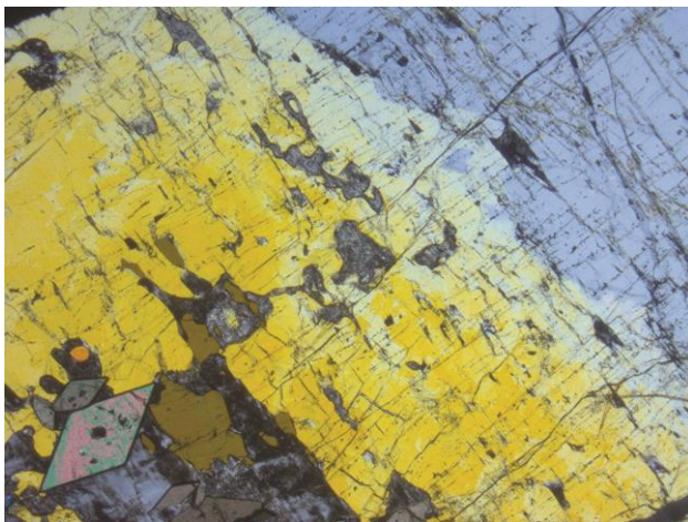
Fig. 12 Tynnslip (polarisert lys) av pegmatittisk materiale med <2,5 cm store korn/krystaller av sonert epidot. Denne røde kjernen framstår med kun grålige interferensfarger (bildets øvre/høyre del), med en skarp overgang mot gul interferensfarge på den ytre, mørkegrønne sonen. Nedre/venstre sees en del inntil 1 mm store, euhedrale titanittkrystaller. Billedbredde ca. 4 mm.
