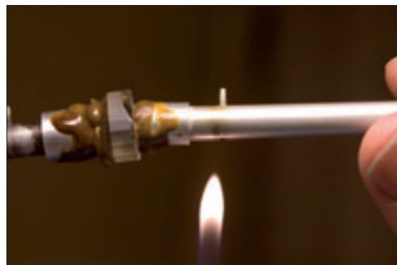
Figur 31. Efter att man känt att stenen sitter fast i nya doppstickan så värms den bort från den gamla doppstickan.
