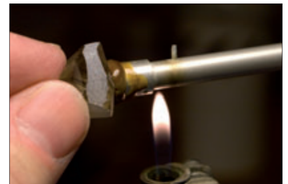
Figur 19. Fastvärmning av stenen på doppstickan med stenlack.
