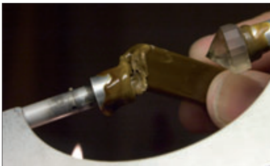
Figur 28. Påfyllnad av den urkonade doppstickan med stenlack. För rektangulära eller ovala stenar så använder man en v-formad doppsticka istället.
