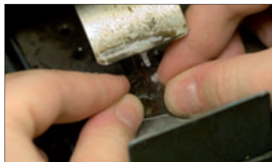
Figur 14. Sågning med hjälp av en liten stensåg gjord för facettstenar med ett tunt sågblad för att spara material.
