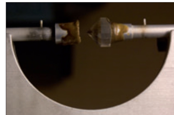
Figur 27. Överföringsjigg där stenen skall flyttas över till nästa doppsticka för att kunna slipa översidans ytor (kronan). Stenen skall flyttas till en urkonad doppsticka.
