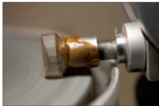
Figur 32. Kontrollslipning vid 85° för att se till att stenen överförs rätt.
