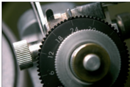
Figur 3. Indexhjul med låsmekanism.
