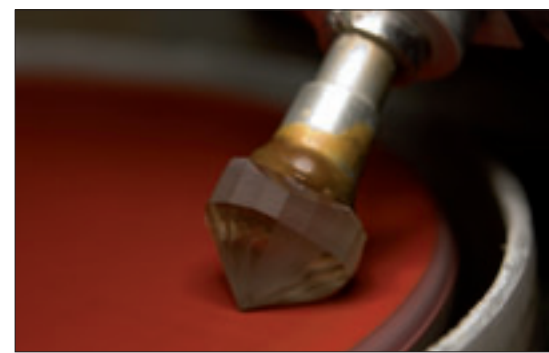
Figur 25. Förpolering pågår med en 600 korns NuBond-skiva. Vattenkylning har man hela tiden via droppande från vattenflaska.
