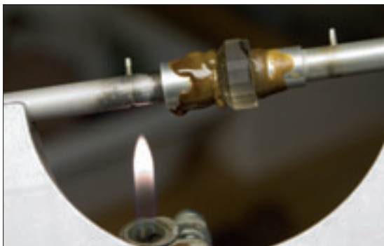
Figur 29. Fastvärmning av stenen i den andra doppstickan. Med fördel kan man öka doppstickans storlek om man ser att det går; då kommer stenen att sitta ännu säkrare.
