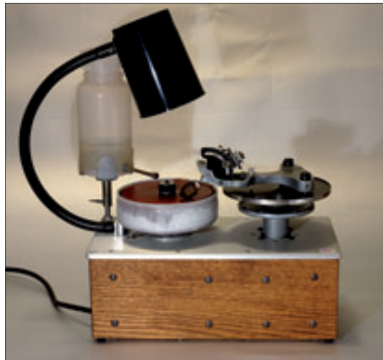
Figur 1. Facettslipmaskin av plattformstyp, Raytech Shaw.
