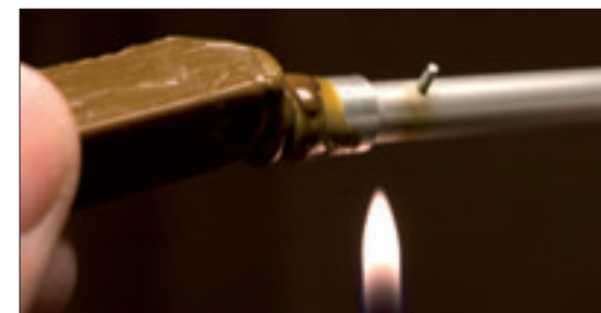
Figur 18. Fastvärmning av stenlack för doppstickan.
