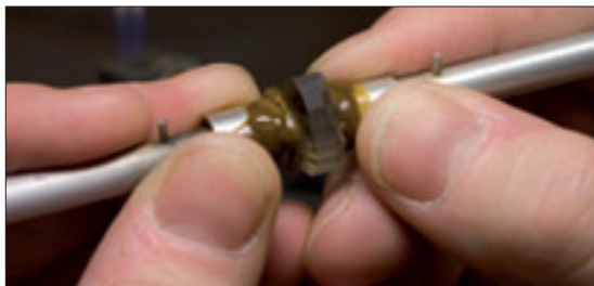
Figur 30. Känna efter att stenen sitter fast i den nya doppstickan.
