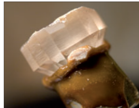
Figur 33. Den vända stenen har linjerats. Kontrollytans skarv är parallell med skarven mellan rondist och paviljongyta.
