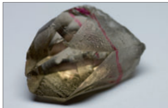
Figur 13. Uppmärkning av delar som skall sågas bort. T.ex. för att få bort sprickor och grums.
