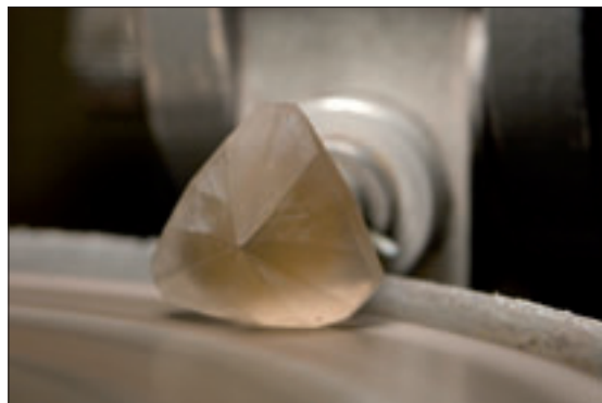
Figur 21. Slipande av stenens rondistytter, vilket ger stenen dess yttre form.
