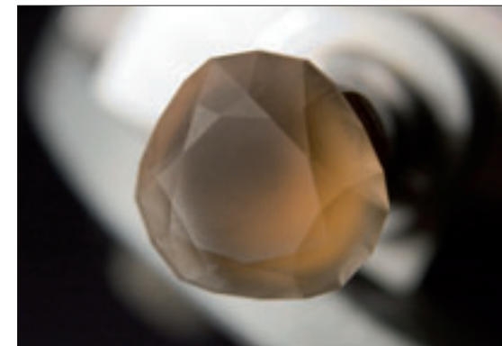
Figur 35. Finslipning klar. Rondisten slipad till färdig bredd och alla ytor slipade med perfekta möten.
