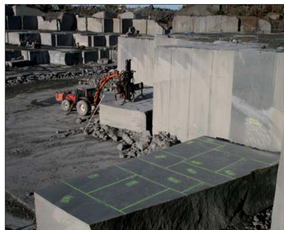
Store blokker av larvikitt skjæres ut av fjellet. Fra Skallist larvikittbrudd, Tjølling.
