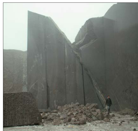
Det er størrelse over benkene som sages, sjekk målestokken (min sønn er ikke kortvokst).
