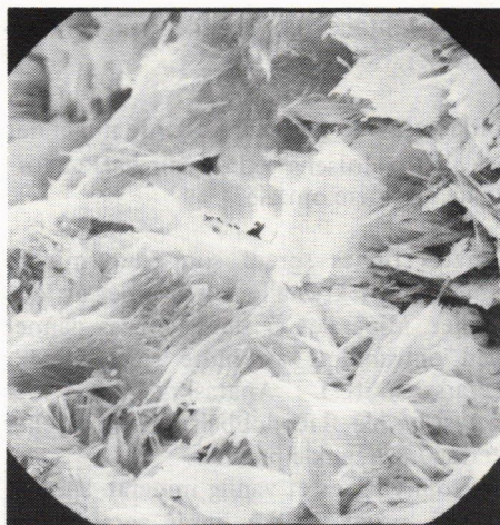
Gearksufitt-krystaller. SEM-bilde 1370 ganger forstørret. (Samling og foto Knut Eldjarn).
