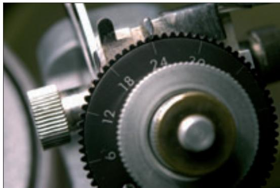
Figur 3. Indexhjul med låsmekanism.
