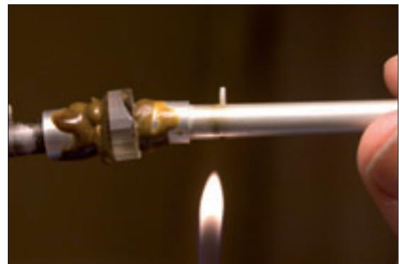
Figur 31. Efter att man känt att stenen sitter fast i nya dopstickan så värms den bort från den gamla dopstickan.
