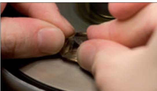
Figur 15. Slipande av plan yta för doppstickan.
