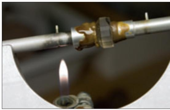
Figur 29. Fastvärmning av stenen i den andra dopstickan. Med fördel kan man öka dopstickans storlek om man ser att det går, då kommer stenen att sitta ännu säkrare.
