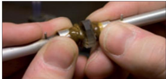
Figur 30. Känna efter att stenen sitter fast i den nya dopstickan.
