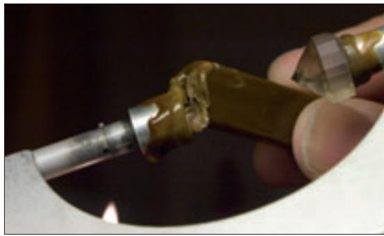
Figur 28. Påfyllnad av den urkonade dopstickan med stenlack. För rektangulära eller ovala stenar så använder man en v-formad dopsticka istället.
