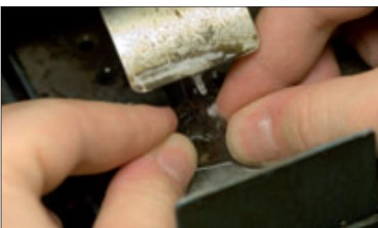
Figur 14. Sågning med hjälp av en liten stensåg gjord för facettestenar med ett tunt sågblad för att spara material.
