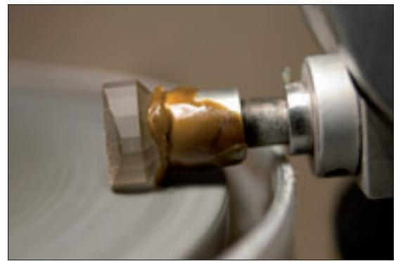
Figur 32. Kontrollslipning vid  $85^\circ$  för att se till att stenen överförs rätt.
