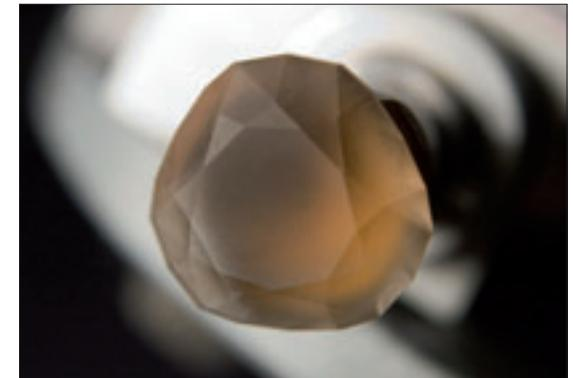
Figur 35. Finslipning klar. Rondisten slipad till färdig bredd och alla ytor slipade med perfekta möten.
