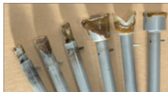
Figur 17. Val av en doppsticka med lämplig storlek. Man har tre doppstickor av varje storlek, en plan, en urkonad och en V-formad. Den plana skall användas till att börja med.
