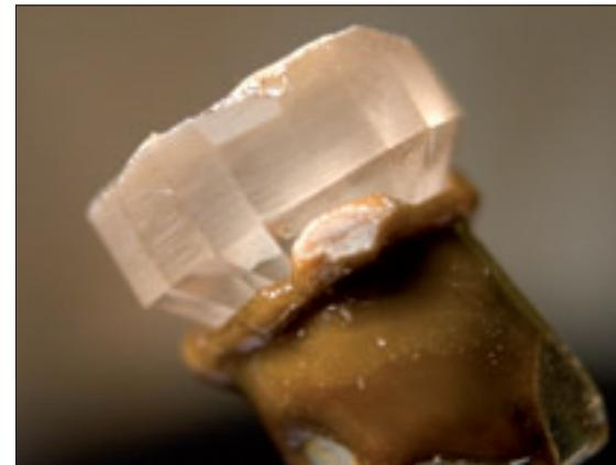
Figur 33. Den vända stenen har linjerats. Kontrolllytans skarv är parallell med skarven mellan rondist och paviljongyta.
