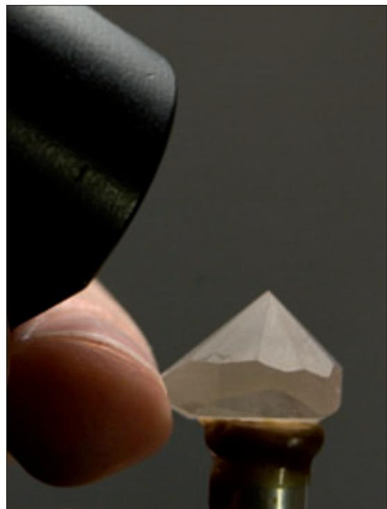
Figur 22. Se till att ha tillräckligt med material för övre delen av stenen. Luppen är också ett standardhjälpmittel för att se att mötena blir rätt.
