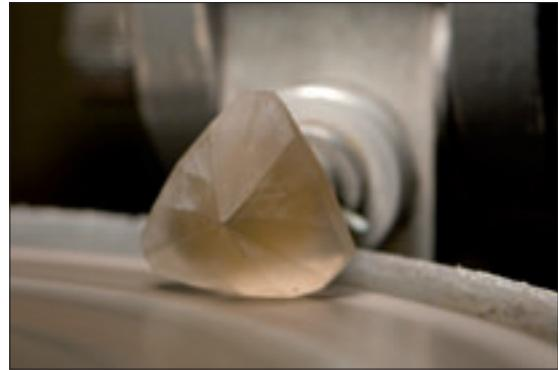
Figur 21. Slipande av stenens rondistytor, vilket ger stenen dess yttre form.
