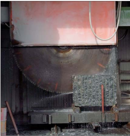
Tilsaging av stor larvikittblokk hos Strandberg Stein ved Larvik. Som det fremgår av bildet, er det store dimensjoner i sving!
