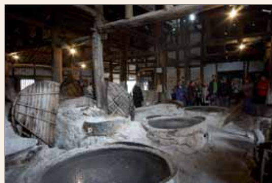
Saltlake pumpes opp fra undergrunnen og kokes inn.
